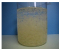
10分間攪拌後の フロック形成・架橋状況
