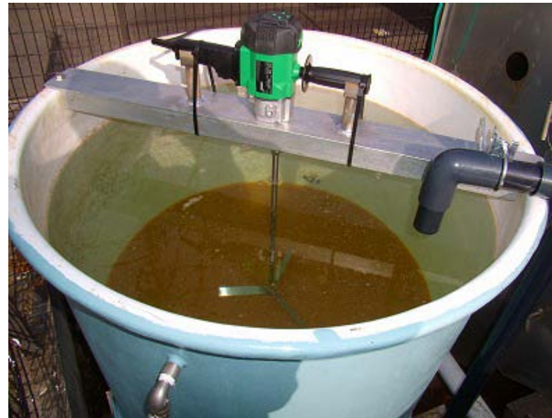
凝集分離状況
